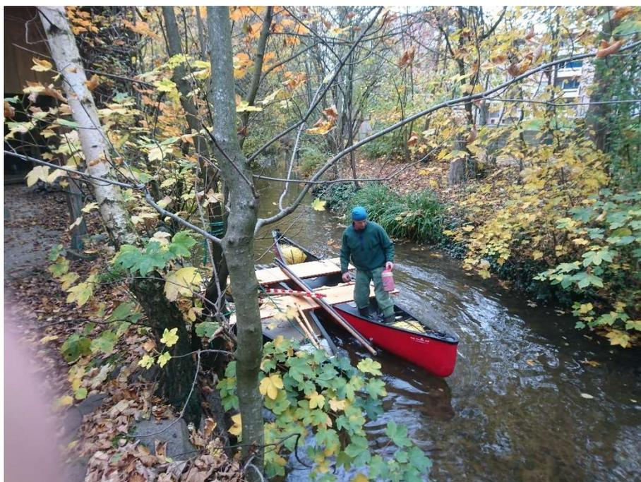
Abb. 13: Plattform zur Probenentnahme, auf zwei Kanus montiert.
